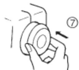
⑦ Нажмите на маховое колесо и снова подключите его. (Игла машины не будет двигаться без подключения махового колеса.)
