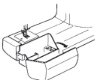
Потяните за конец выдвижного столика в противоположную от машины сторону как показано на рисунке.
