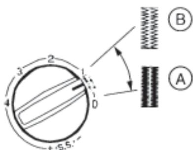
Для легких тканей используйте меньшую длину стежка **A**. Более длинные стежки нужны для тяжелых тканей **B**.
