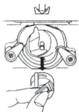
Поверните на себя маховое колесо, поднимите иглу. Потяните вверх за язычок и вытащите шпульный колпачок.
