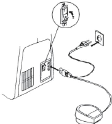
Ваша машина оснащена съемным шнуром. Перед подключением машины убедитесь, что напряжение и частота тока, указанные на машине, соответствуют напряжению и частоте тока в Вашей квартире.
