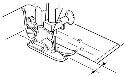
Линии на игольной пластине помогут Вам отмерять ширину швов.
